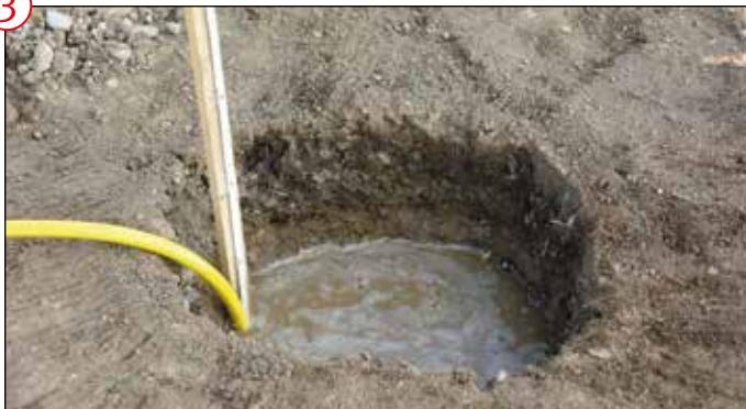
Die Grube ca. 30 min. wässern, um den Boden anzufeuchten. Vor Beginn des Versuchs muss die Grube komplett entleert werden.
