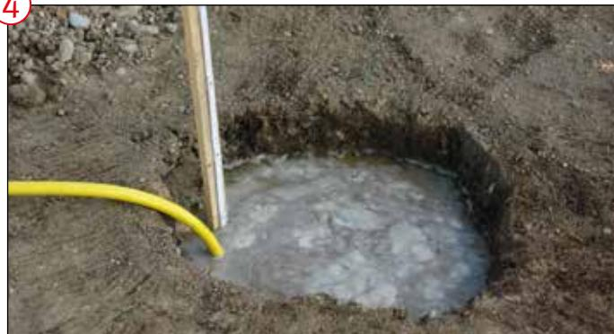
Die Grube zu ca. 20 cm mit Wasser füllen, Uhrzeit und Wasserstand notieren.
